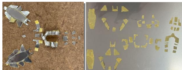
写真2.チタン板の切断・調整
