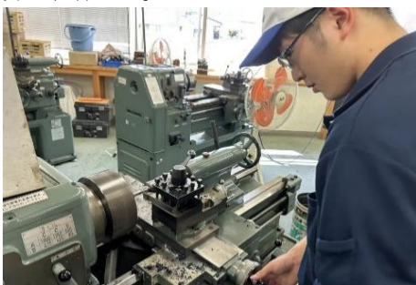
図1 シャフトの切削加工の様子
